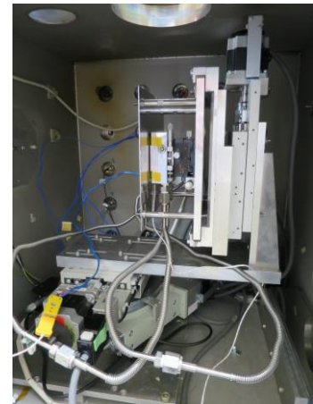
図1: 露光用チェンバー内に設置した露光用治具と冷却用治具。熱電対による温度モニターを行っている。
