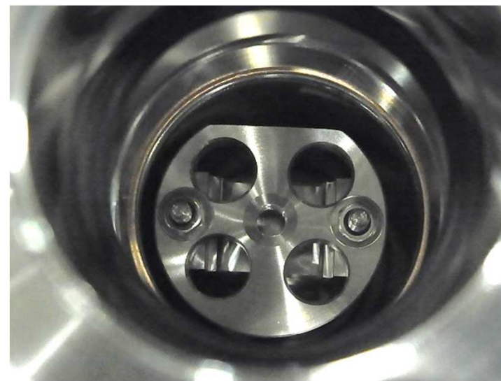
溝にはまり固定された状態
