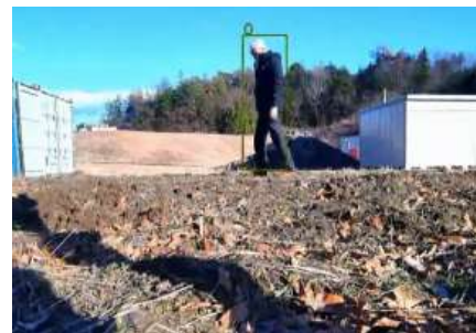
【模擬農地 カメラ移動台車搭載】 ジンバル画像安定化 ⇒ 複雑背景でミス
