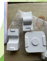
スラリー成形法によるセル成形試作
