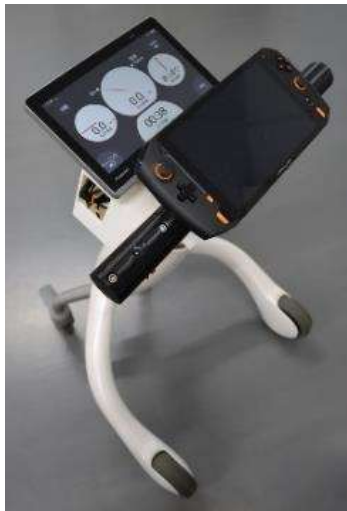
生体情報計測機能を実装した歩行支援デバイス
